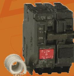
Estos interruptores de circuito de falla a tierra eliminan la necesidad para receptáculos separados de GFCI, protege contra cortocircuitos y sobrecargas, además previene un shock eléctrico, discerniendo los niveles muy bajos de descargas y abriendo inmediatamente el circuito, protegiendo la vida de la persona.
