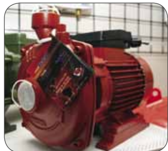
Bomba centrífuga IHM. I, 1.5 y 2 HP. Caudal máximo 30 galones por minuto. Presión máxima 50 Psi.
