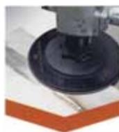
3M recomienda utilizar un disco de fibra 785C ó 985C, Disco Flap 747D, banda de lija 777F, 3M Cubitrón™ cerámico, grano 60.
