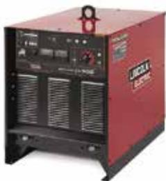
**CV 400.** Equipo tanto para procesos MIG como para procesos de Flux Core (o alambre tubular). Se puede conectar en redes eléctricas que van desde los 230 voltios hasta los 575 voltios, exclusivamente en trifásico. Posee un rango de soldadura que comienza en 60 amperios y llega a un máximo de 500. Posee un ciclo de trabajo de 100% a 400 amperios.
