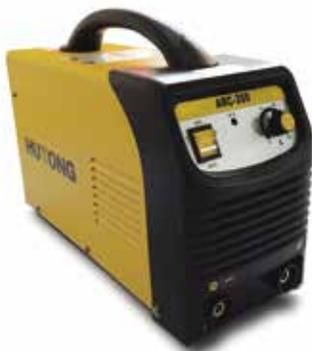
**Modelo: ARC-200.** Tecnología de inversor, para soldar cualquier tipo de electrodo revestido. Puede trabajar al 100% con electrodos de 5/32" (Ciclo de trabajo de 155 amperios a 100%). Incluye: 2m cable portaelectrodo y portaelectrodo, 2m de cable a tierra y prensa a tierra, 1,5m de cable de entrada con enchufe 220V (lista para conectar). Bajo consumo de corriente. Peso: 7,9kg. Dimensiones: 24cm X 16cm X 40cm.
