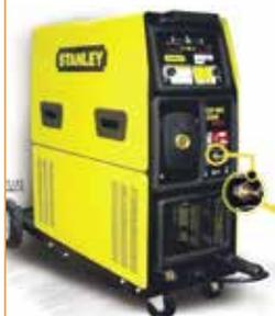
**TOP MIG 2500** Stick / MIG / TIG. Inversor de uso industrial. Voltaje: 230/400. Rango de corriente (Amperios) 20 - 240. AC equivalente en amperios ~320. Tensión en vacío: 100. Ciclo de trabajo: 35%. Tamaño de electrodos: 1/16"-13/64"; .03"-.04". Tipo de electrodos: varios. Tipos de materiales: acero, acero HSS, inoxidable, latón, aluminio, aleaciones. Grosor de los materiales: 1". Peso: 88 lbs. Enfriamiento: turbo fan
