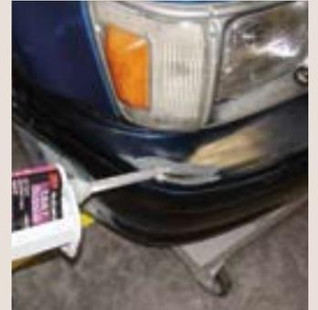
**Sistema de reparación de Bumper Automix - Duramix 4247 de 3M**
