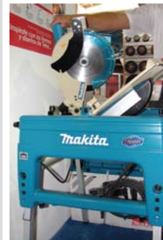
Sierra de doble propósito utilidad de Makita, que puede ser usada como prensadora o como ingleteadora.
