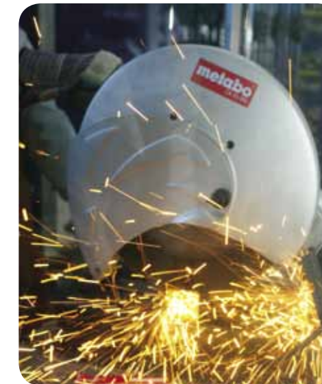
Tronzadora Metabo CS23-355. 2300 vatios y de 355 mm para metal. Ajustable 15 y 45 grados.
