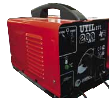
Máquina para soldar. 200 amperios, 110-220 V. Monofásica, corriente AC. Arrollado de cobre con ventilador. Marca Helvi.
