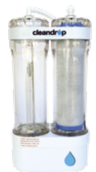
Cleandrop Purificadores de Agua. Combina cuatro tecnologías: ozono, luz ultravioleta, fotooxidación y filtro de carbono que permiten eliminar bacterias, microorganismos u otras sustancias que pueda contener el agua.
