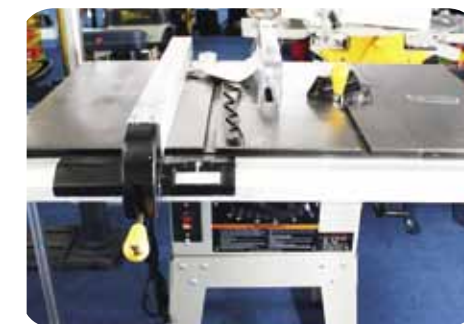
Sierra mesa para madera. Capacidad 10". Capacidad de corte de 80 m. Inclinación mesa 45 grados. 2 Hp, 4000 Rpm. Marca Total Tools.
