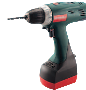
Taladro/destornillador electrónico a batería 12 voltios, BSZ-12 METABO. Sistema electrónico Variospeed (V). Par de giro ajustable a 20 niveles más fase de taladrado. Carcasa de engranaje de fundición de aluminio a presión. Baterías recargables hasta 2000 veces (con ACS 15: 3000 veces), gracias al proceso de carga cuidadoso.
