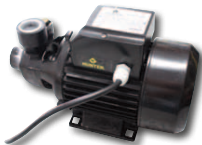
Bomba para agua 1 HP, 120V. Salida y entrada de 1 pulgada. Marca Hunter.
