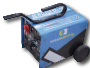
Soldadora modelo SLD-TW-1001. Voltios de alimentación: 115 / 230 V, 60 Hz. Voltios de circuito abierto: 50 V. Sistema de enfriamiento con ventilador. Capacidad de entrada: 9.5 KVA
