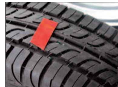
Se observa cómo el producto (de color verde) actúa sellando la perforación.
