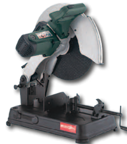
Tronzadora de banco de 2300 vatios y de 355mm para metal, ajustable 15° y 45° CS 23-355 METABO. Con manigueta para su transporte a mano. Ajuste de profundidad de corte. Ángulo de prensa ajustable de -15° a +45°. Tolerancia de corte: ± 1°. Indicada para cortar acero, acero inoxidable, acero colado, cobre, aluminio y otros metales.
