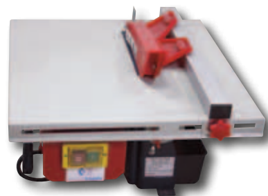
Cortadora de cerámica HEL-DO-3025. Tamaño de la mesa: 400 X 380 mm. Diámetro de la rueda: 180 mm, Inclinación de motor: 0 - 45 grados. Máximo altura de sierra: 35 mm. Potencia: 500 watts 2/3 hp.
