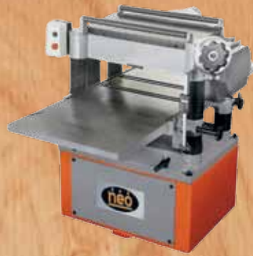
Cepilladora neo 20", 2230 Watts, 3 Hp, 220 Voltios. Monofásica.
