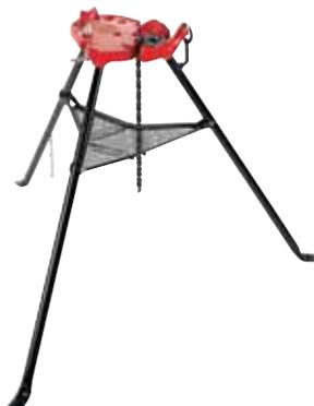
Banco de trabajo, modelo 460. Para trabajar tuberías de 1/8 a 6". Igualmente, el modelo 425 para tuberías de 1/8 a 2 1/2".
