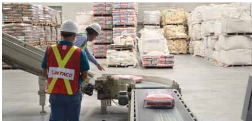
El proceso productivo de la máquina de INTACO inicia desde la clasificación de las materias primas, hasta el entarimado de los sacos.
